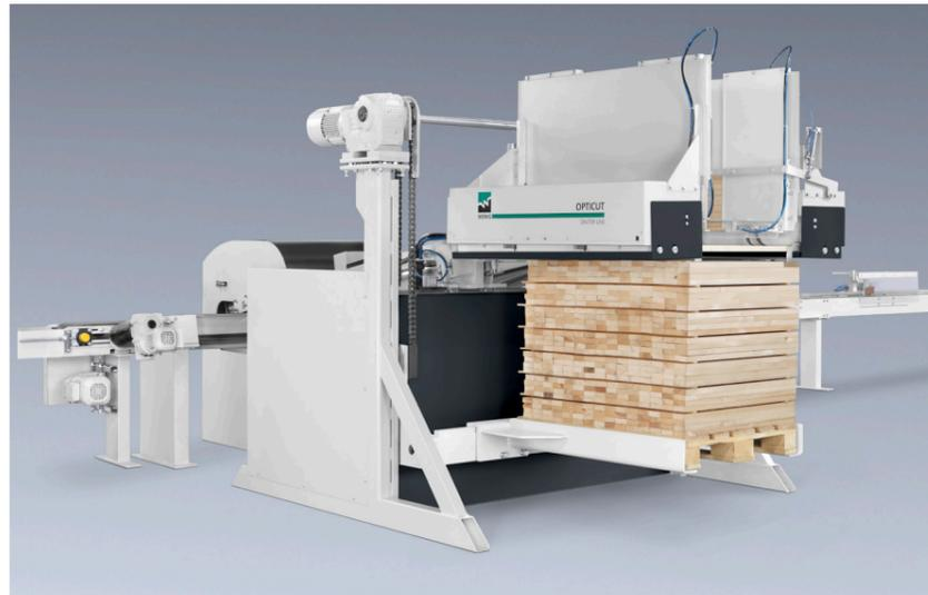
La **OptiCut Stacker** es la mejor solución para la producción de piezas con largos preferenciales. Las piezas son apiladas automáticamente hasta una altura de 1200 mm y una frecuencia desde hasta 80 piezas/min. En el control se pueden elegir diferentes tipos de apilamiento.
