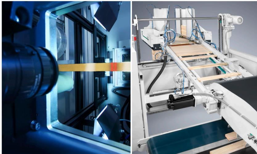
**El Weinig sistema de Scanner** registra en forma automática y rápida los defectos de la madera, como ser los nudos, grietas y defectos de contorno y provee los datos de optimización a velocidad de producción para hasta 4 sierras OptiCut respaldado por una mecanización inteligente.
