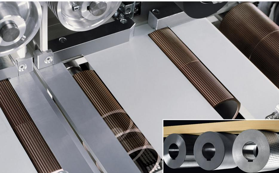
Cada calidad de madera exige un tratamiento específico. La OptiCut 200 permite el cambio de rodillos con rapidez adaptándose a las exigencias. La madera rústica y cepillada se procesa rápidamente y sin dificultad en el mismo turno. Rodillos con resina pueden ser limpiados fácilmente, garantizando la mayor capacidad en cada turno.
