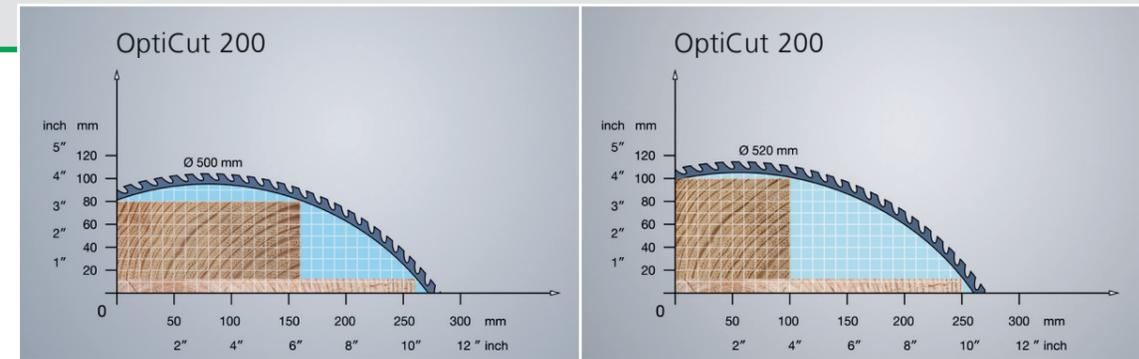
Atención: para determinar la sección transversal hay que considerar alabeos y dimensiones variables de madera. ¡Son válidas las secciones transversales nominales indicadas en los datos técnicos!
